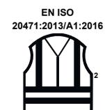
Este pictograma indica que es un equipo de protección individual para la señalización de alta visibilidad de clase 2 (superficie mínima de materiales de fondo y de material retrorreflectante).
